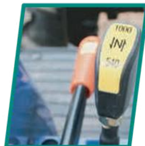
Toma de fuerza combinada 540 - 1000 RPM, con palanca de activación directa
