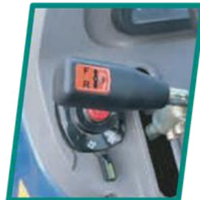
Caja de cambios tipo Shuttle
