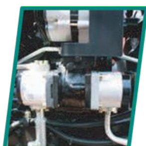
Sistema hidráulico separado (TANDEM)
