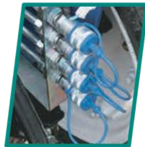
Caja de válvulas dobles
