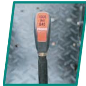
Toma de fuerza combinada 540 - 1000 RPM
